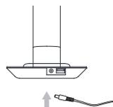
將DC接頭插入產品背後的對應孔位後，然後將變壓器接上AC電源。
