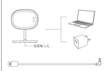
產品內置鋰電池(鋰電池版),可通過USB線連接變壓器或者電腦使用、充電。接入電源後檯燈會緩慢點亮兩次,提示進入充電狀態。 關燈狀態充滿一次電,需要3小時。
