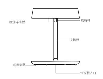
化妝鏡可前後180度旋轉調節適合角度;檯燈擁有燈光記憶功能;產品內置 鋰電池(鋰電池版),可充電使用。
