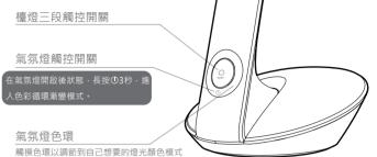
**示意圖** ● 請勿將檯燈放置於超過6°角平面
